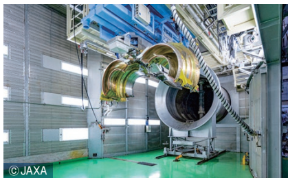
地上エンジン運転試験設備
