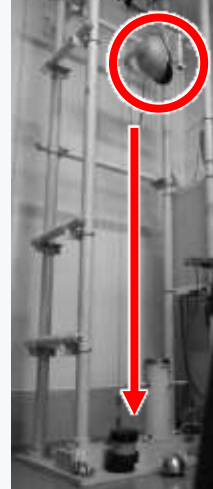
衝撃吸収性試験の様子
